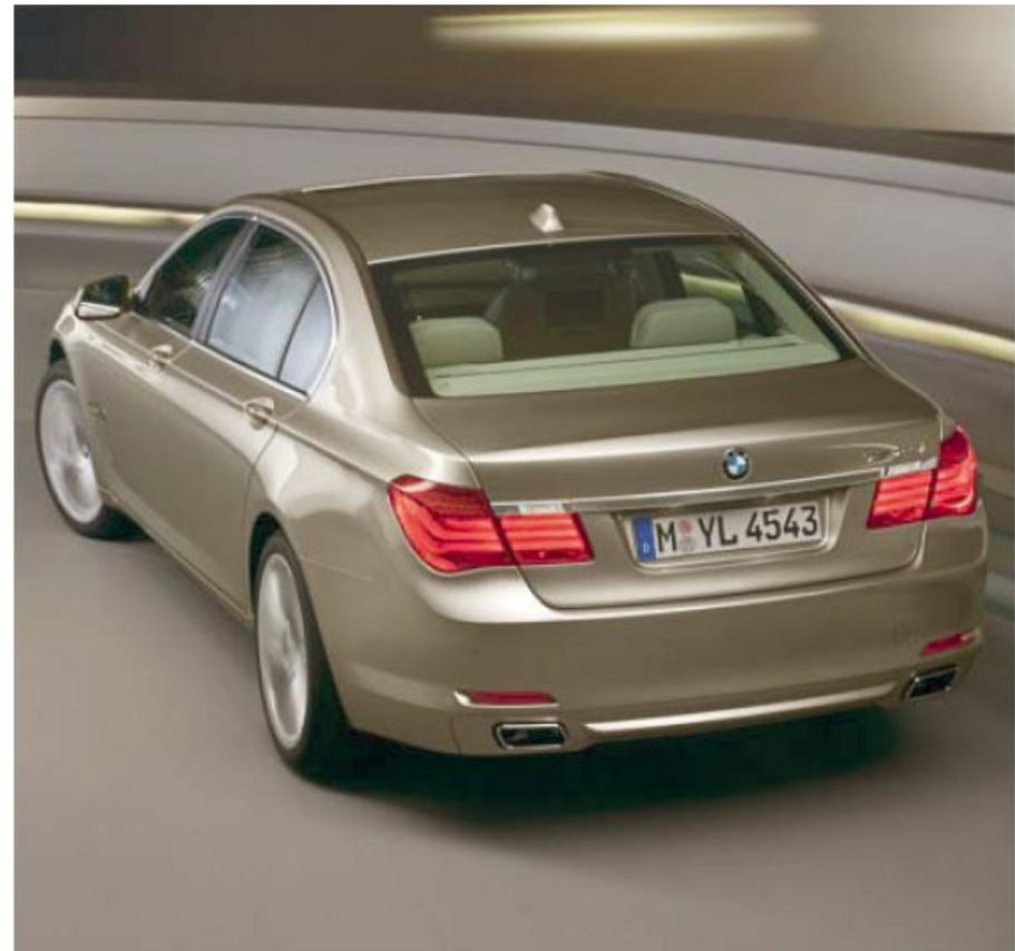
на светодиодных элементах и излучают теплый, однородный свет. Сигнал указателей поворота генерируется по светодиодной технологии. Источником света третьего стоп-сигнала, расположенного у верхней кромки заднего стекла, и фонаря освещения номерного знака также служат светодиоды.
