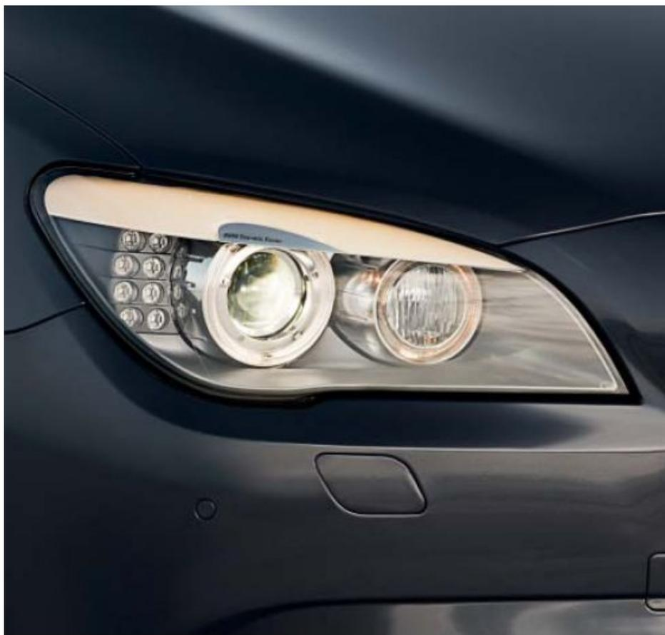
**Оптимальная видимость: биксеноновые фары серийно, адаптивная система освещения поворотов и система распределения светового потока в качестве опции.**
