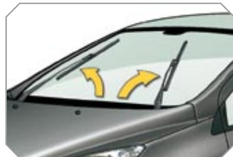
До истечения первой минуты после выключения зажигания переведите рычаг включения стеклоочистителя в любой режим: щетки стеклоочистителя займут положение посередине ветрового стекла и останутся. Это позволит поднять щетки при парковке автомобиля на морозе, очистить их или заменить. Чтобы уложить щетки в исходное положение, включите зажигание, а затем - стеклоочиститель.
