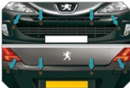
Она срабатывает при приближении к какому-либо препятствию (напр., к человеку, автомобилю, дереву, изгороди, ...), расположенному сзади, однако на препятствия, расположенные под бампером, система не реагирует.
