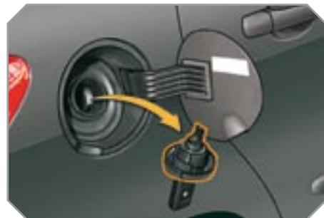
По окончании заправки топливного бака :
