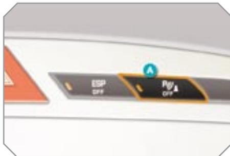
☞ Нажмите на кнопку **A**, при этом загорится сигнализатор и система отключится.
