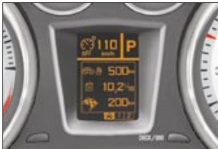
**i** В зависимости от комплектации автомобиля информация бортового компьютера может выводиться либо на монитор, либо на большой дисплей панели приборов.
