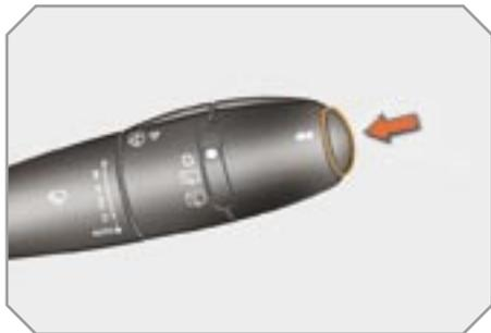
☞ Нажмите на кнопку, расположенную на торце **выключателя стеклоочистителя**, чтобы последовательно вывести на дисплей компьютера различные параметры.
