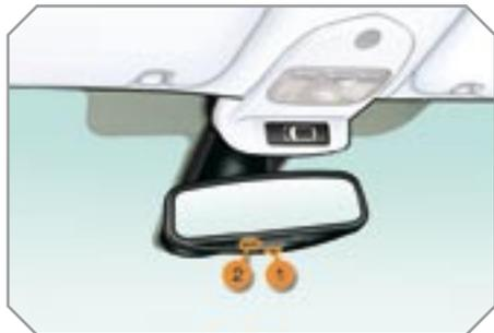
Чтобы защитить водителя от слепящего действия света фар автомобилей, движущихся сзади, это зеркало автоматически затемняется тем больше, чем ярче направленный на него свет.
