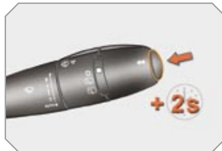
☞ Нажмите более двух секунд на кнопку, чтобы обнулить счетчик пройденного расстояния, индикатор среднего расхода топлива и параметр средней скорости движения.
