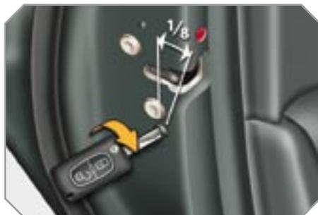
☞ Вставьте ключ в расположенный на торце двери замок и поверните его на 1/8 оборота.
