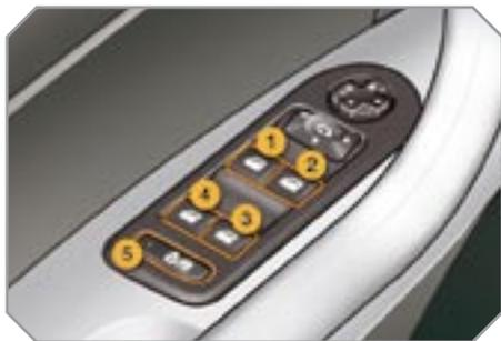
1. Выключатель стеклоподъемника двери водителя.
