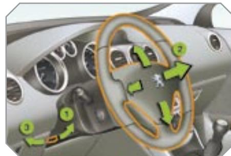
1. Снятие блокировки механизма регулирования.
