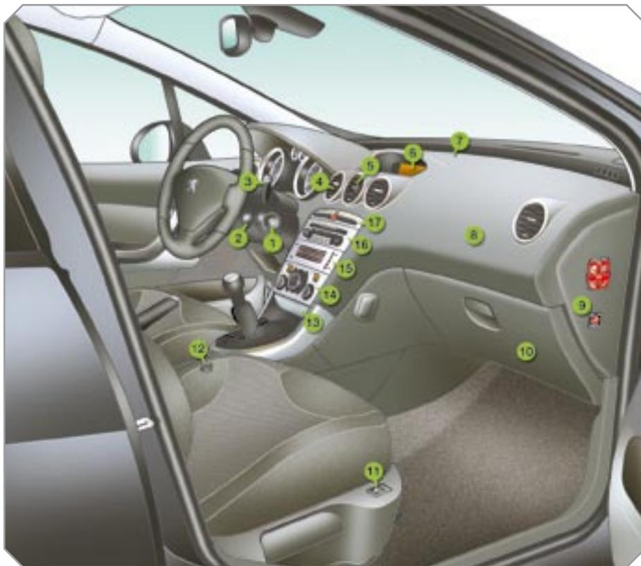
1. Замок зажигания с противоугонной блокировкой.
