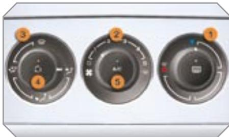
Системы отопления, вентиляции и кондиционирования воздуха работают только при запущенном двигателе.
