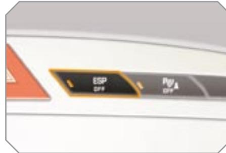
☞ Нажмите на кнопку **"ESP OFF"**, расположенную в центре панели приборов.
