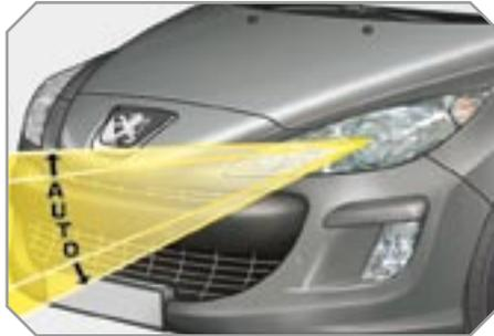
Чтобы не ослеплять других участников дорожного движения, автоматический регулятор корректирует на остановленном автомобиле угол наклона световых пучков ксеноновых фар в зависимости от загрузки автомобиля.
