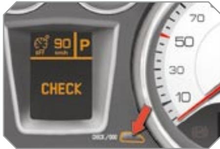
Для включения самодиагностики бортовых систем автомобиля запустите двигатель и нажмите на кнопку "CHECK/000", расположенную на панели приборов.
