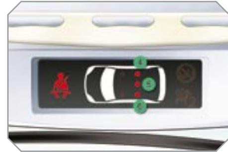
При включении зажигания загорятся соответствующие красные контрольные лампы 4, 5 и 6 примерно на 30 секунд, если ремень безопасности не пристегнут.
