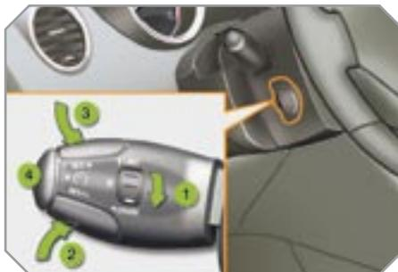
1. Активирование/Отключение функции регулирования скорости.
