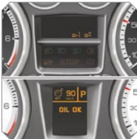
Индикатор показывает в течение нескольких секунд уровень масла в системе смазки двигателя при включении зажигания, сразу после информации о предстоящем плановом техническом обслуживании.
