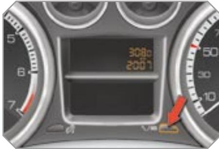
Общий пробег и расстояние, пройденное за поездку показываются на дисплее в течение 30 секунд при выключении зажигания, при открывании двери водителя, а также при запуске и отпирании автомобиля.
