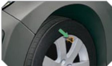
Во время движения специальные вмонтированные в вентили датчики включают соответствующий сигнализатор при падении давления ниже нормы (на скорости выше 20 км/ч).
