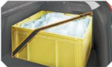
Лямки цепляются к багажным кольцам, чтобы закрепить сложенные в багажнике вещи.
