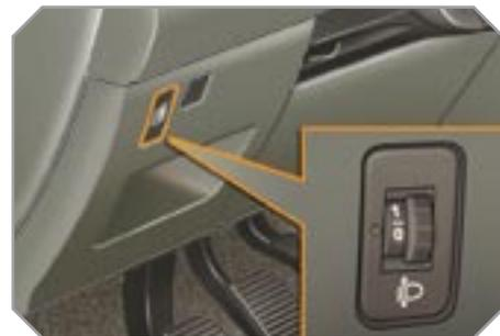
Чтобы не ослеплять других участников дорожного движения, необходимо отрегулировать угол наклона световых пучков фар с галогенными лампами в зависимости от загрузки автомобиля.
