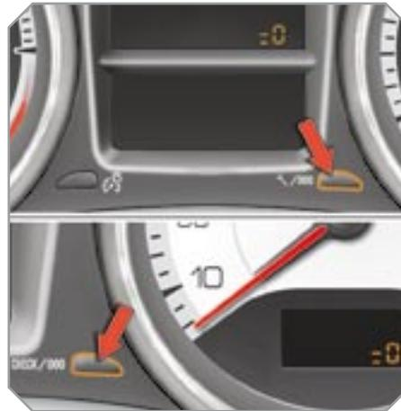
После прохождения очередного планового технического обслуживания счетчик указателя следует вновь установить на ноль.
