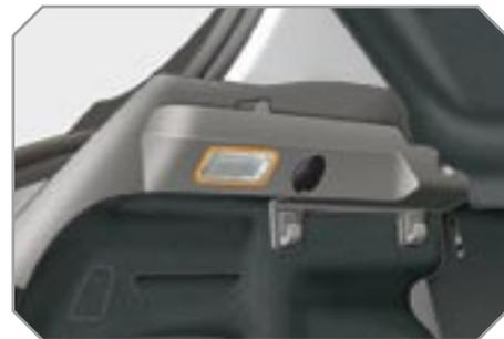
Он загорается автоматически при открытии и гаснет также автоматически при закрытии дверцы задка.
