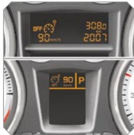
При активировании работы регулятора или ограничителя скорости на панели приборов загорается соответствующая контрольная лампа.
